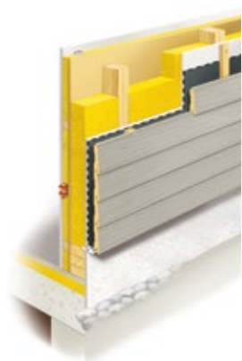
Wandaufbau der Holzskelettbauweise.
